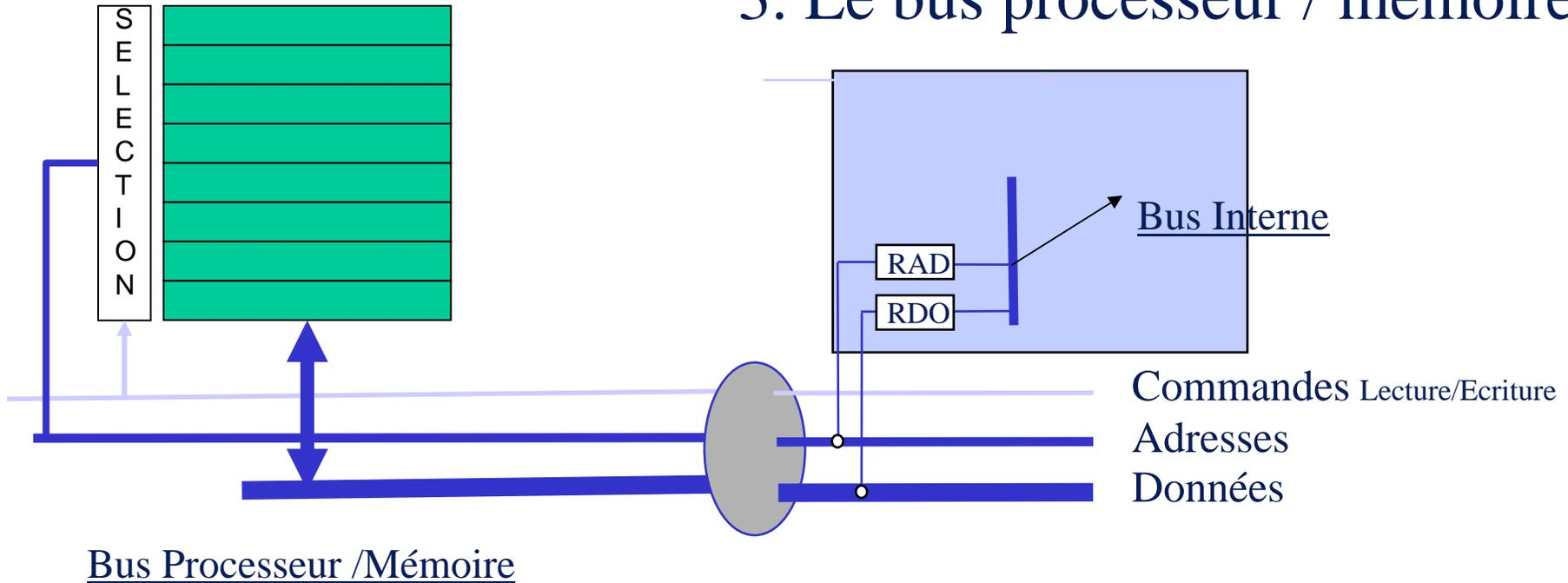
Le bus processeur/mémoire permet la communication entre le processeur et la mémoire centrale. Au niveau du processeur cet interfaçage est mis en œuvre via les registre RAD et RDO.
